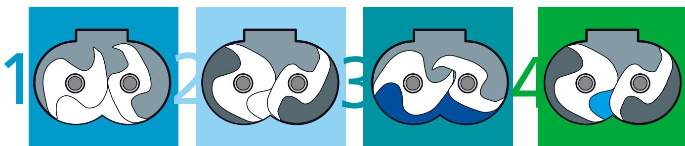
1 环境空气在旋齿式转子的旋转作用下通过进气口被吸入压缩室。
